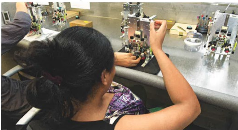
Une collaboratrice en plein «priming», le remplissage de fluides d'un verre de borosilicate dans des corps capillaires.
