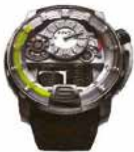
HYT的H1，其破天荒之處是用液體顯示時間，透明背透展現表殼外殼，裡面的螢光液體借助水力壓縮膨脹裝置在管線裡流動，從而指示時間。
